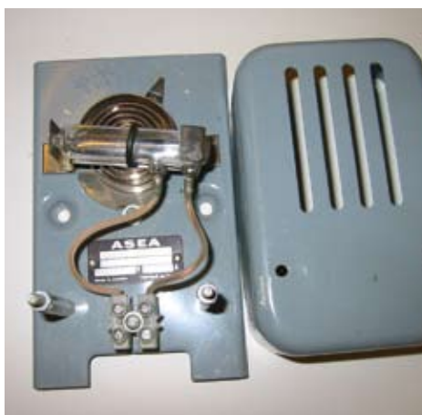
Termostat innehållande kvicksilvrevippa.
