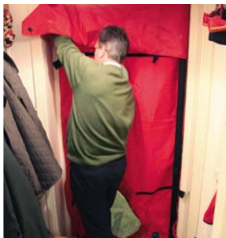
Med värmekameran visar man var bristerna finns i rummet. Fläktarna som monteras i dörren skapar ett undertryck i lägenheten. På dataskärmen får man snabbt upp lägenhetens täthetsvärde.
