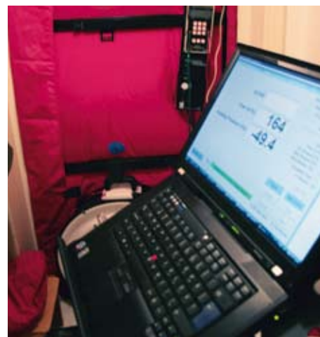
Med värmekameran visar man var bristerna finns i rummet. Fläktarna som monteras i dörren skapar ett undertryck i lägenheten. På dataskärmen får man snabbt upp lägenhetens täthetsvärde.
